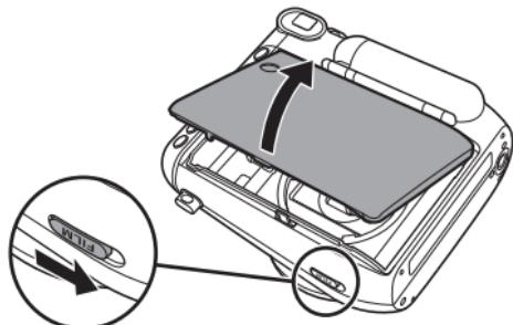
Betätigen Sie die Rückwandsperre, um die Rückwand zu öffnen.
