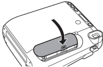
Schließen Sie den Batteriefachdeckel.
