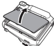
Faites pression sur le verrou du couvercle arrière pour l'ouvrir.
