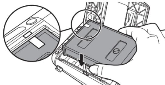
Sujete ambos lados del cartucho de película, haga coincidir las marcas de color amarillo de la cámara y del cartucho de película, e insértelo en línea recta.
