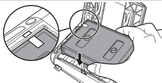
Halten Sie beide Seiten der Filmkassette richten Sie die gelben Markierungen an der Kamera und der Filmkassette aus, und setzen Sie die Filmkassette dann gerade ein.
