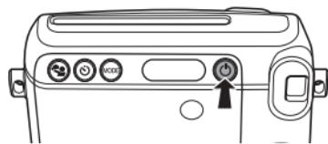
Appuyez sur la touche d'alimentation pour mettre l'appareil photo sous tension.
