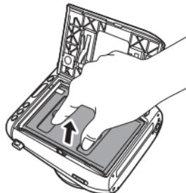
Greifen Sie die rechteckigen Aussparungen an der Filmkassette und ziehen Sie diese gerade heraus.
